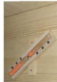
Attaccare alla parete in corrispondenza dei punti preforati e predisposti posti in prossimità della stufa e a ridosso del tetto il Termoigrometro (opzionale) e la clessidra.
