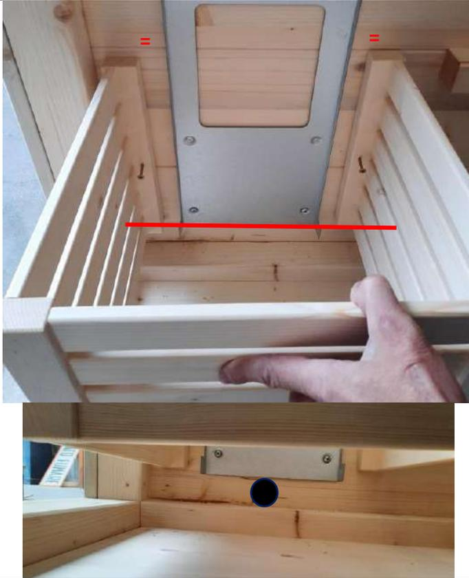
Fissare il copristufa allineandolo con la parte inferiore del supporto stufa
