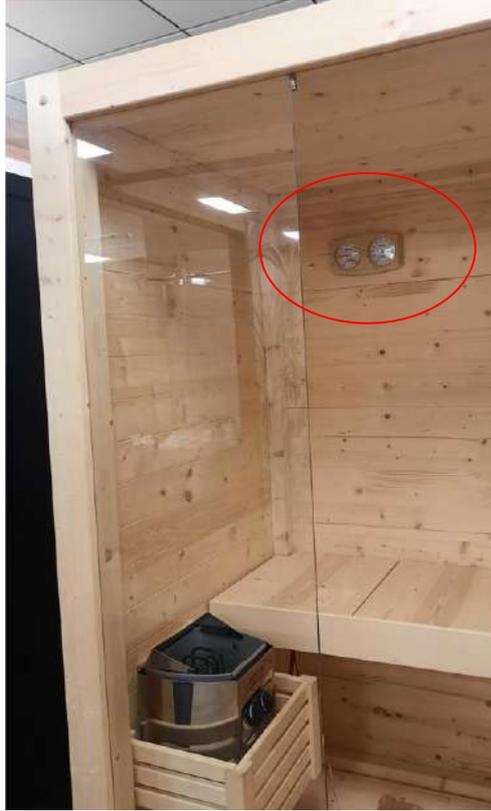
Posizionare il termo igrometro nello stesso lato della stufa a 15cm da tetto.
